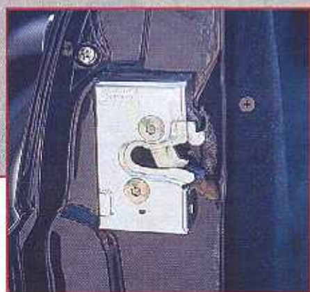
Alle Schrauben wurden gelb verzinkt und in den originalen Zustand versetzt
